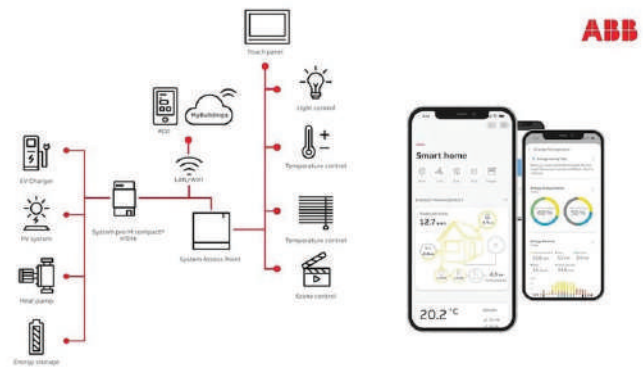
Şekil-3: Örnek bir akıllı ev projesinde entegre edilebilecek sistemlere ait örnek şema
